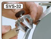
Slijphulpstuk voor kort gereedschap
