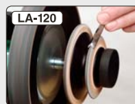
Geprofileerde lederen wetschijf
