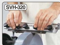
Mal voor machineschaafbeitels
