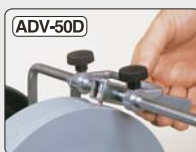
Afdraai-inrichting voor de slijpsteen
