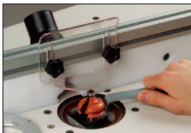
Optionele accessoires Gebogen steeksleutel voor het eenvoudige verwisselen van bovenfreesen.
